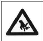
NEHMEN SIE DIE EINKLEMMUNGSGEFAHR (LOSE KLEIDUNG) NAHE AN DEN WALZEN WAHR. AM ORT, WO DER TELESKOPISCHE STAB DURCH DIE WALZEN HINDURCHGEHT, BESTEHT DIE MÖGLICHKEIT EINER SCHNITTBEWEGUNG. DIES KANN ZU EINEM VERWICKELN UND EINKLEMMEN FÜHREN.
