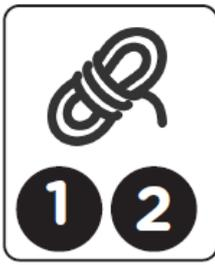
ÜBERPRÜFEN SIE, OB AUF DER ROLLE MINDESTENS 2-3 UMDREHUNGEN DES KABELS AUFGEWICKELT SIND
