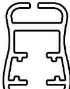
**Unterleiste für Stoffbespannung RBR/1**
