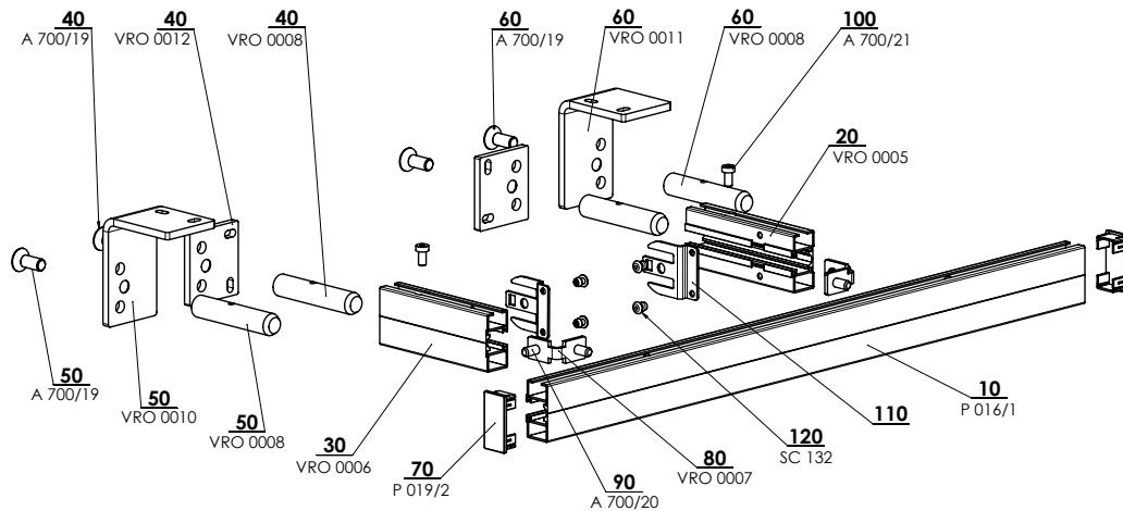
Rahmen mit der flachen Führungsschiene
