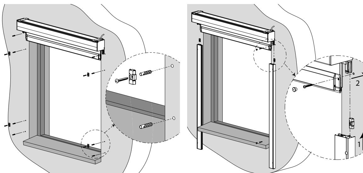
**METHODE 2: Den Screenkasten mit Schienen als Ganzes in die lichte Öffnung oder gegen die Mauer drücken und dann festschrauben.**
