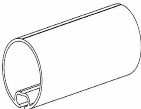
Material: stranggepresstes Aluminium Ø40 mm, Ø55 mm, Ø67 mm, bestehend aus sedimirverzinktem Stahlband für Welle Ø85 mm oder Ø95 mm.
