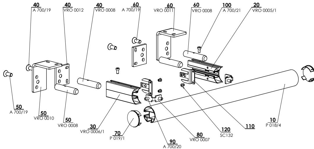
Rahmen mit der runden Führungsschiene
