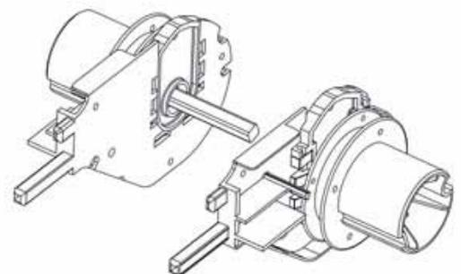
**Achtung:** Die Wellen nur an der erlaubten Stelle koppeln. Da die Motorstärke nach der Anzahl der zu bedienenden Tücher bestimmt wird, ist es nötig dass die Anzahl der angekoppelten Tücher mit dem Zulässigen übereinstimmt.
