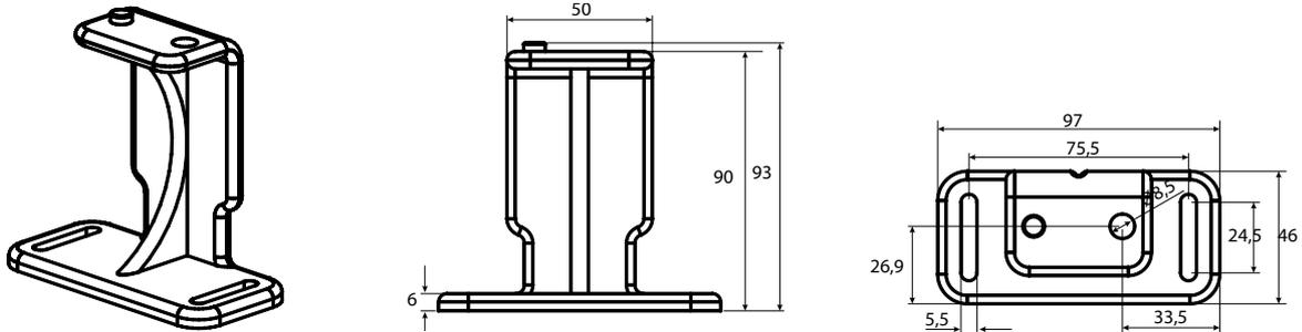
Der Abstand zwischen der Führungsschiene und den Glasprofilen kann mit Hilfe von Abstandhalter vergrößert werden. (siehe Abstandhalter Av, Bv und Cv).
