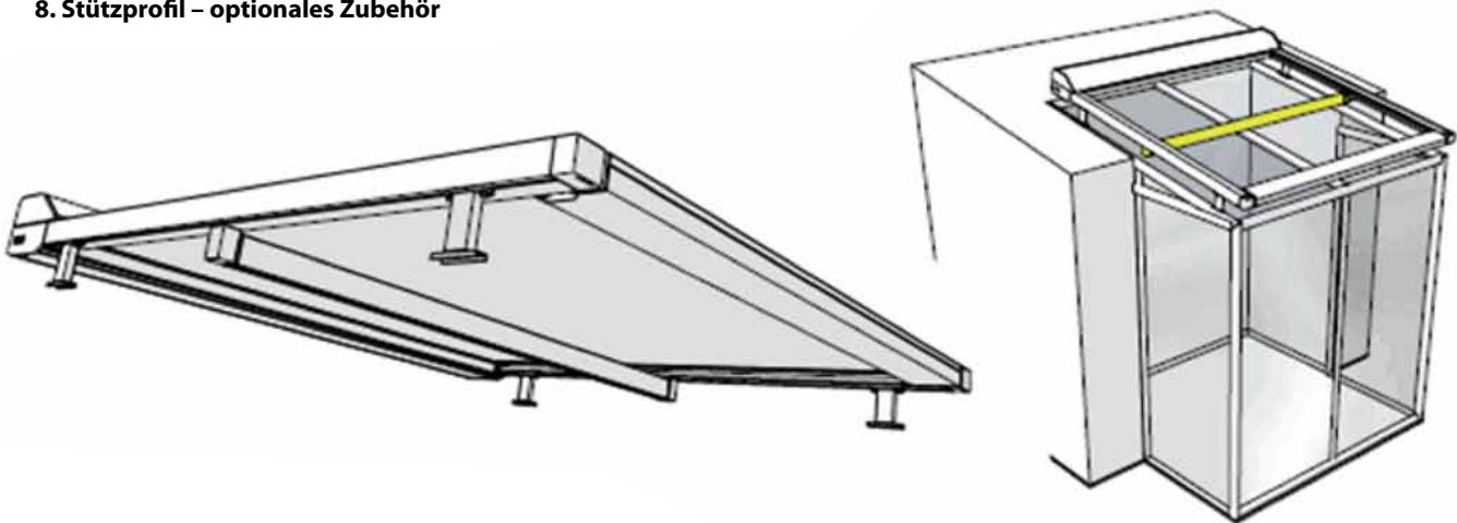
Das Stützprofil wird immer in fester Position in der Mitte der Führungsleisten installiert
