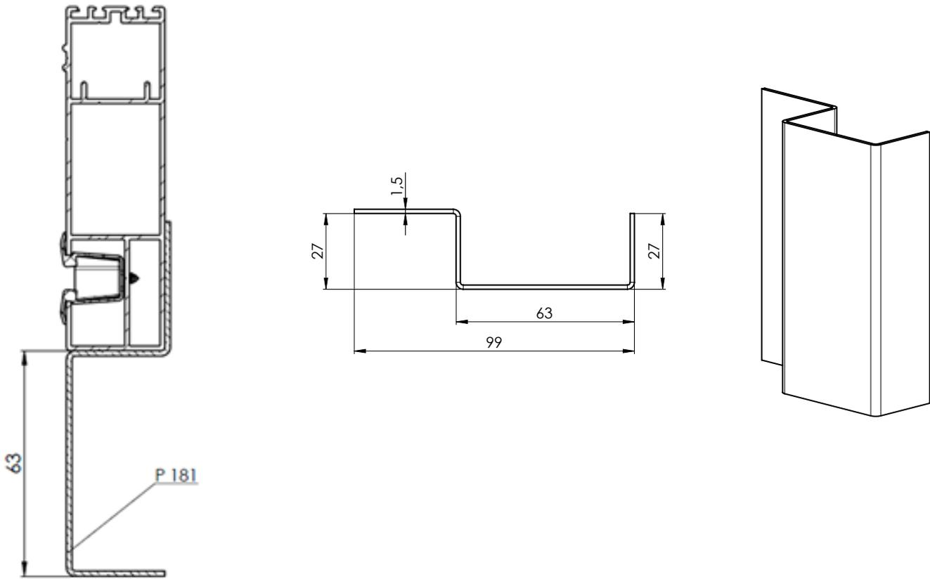
**Schnitt durch die Führungsleiste**
