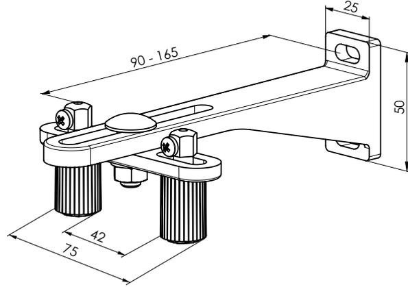
Spannwinkel doppelt, 120 - 200 mm P032/10 (2-01650)
