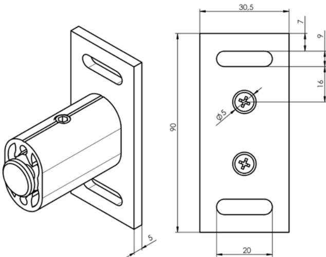
Befestigung der Führungsschiene
