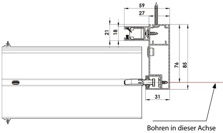
**Schnitt durch die zusammengesetzte Führungsleiste**
