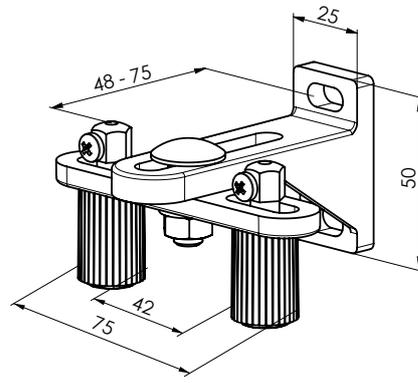
Spannwinkel doppelt, 70 - 130 mm P032/8 (2-01652)
