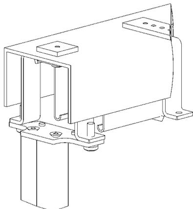
**ACHTUNG: Berücksichtigen Sie bei der Eingabe der Maße, dass das Fertigungsmaß der Höhe der Jalousie um 18 mm kleiner ist als das tatsächliche Gesamtmaß der fertigen Jalousie einschließlich des Versteifungsprofils und der Blechhalter.**
