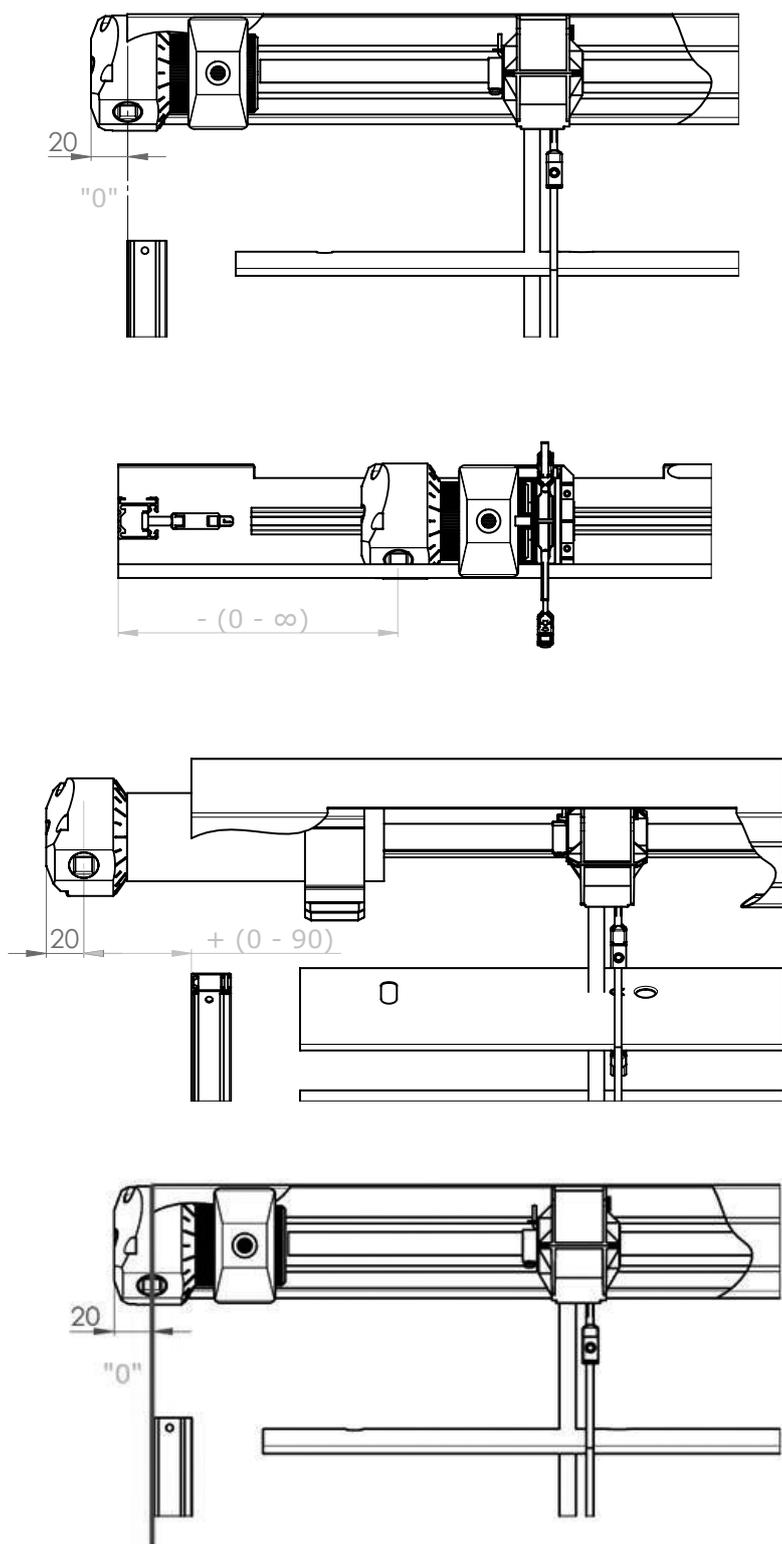
Die Getriebeposition (mögliche Verschiebung) in Oberschiene hängt vom jeweiligen Bestückung des Fensterrahmens, der Leibung ab. Die Getriebeachse ist der Abstand der Achse der Getriebemitte vom Außenrand der Führungsschiene, gegebenenfalls vom Außenrand der Lamelle bei der Stahlseilführung.
