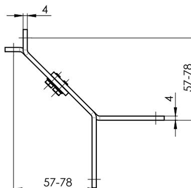
**Führungsschienenhalter, eckig außen 100 – 140 P 098/2 (2-01152-PU11)**
