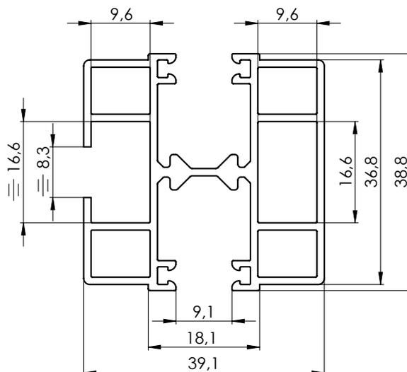
**Hanger der oberen Leiste mit dem Halter (Fe) P002/14 (2-01684) der Führungsleiste P016/2**
