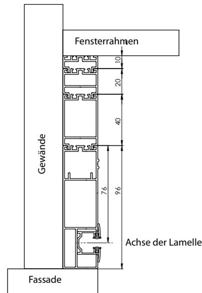
**Anpassungsprofile für die Führungsleiste P 020 und P 081**
