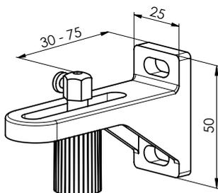
Spannwinkel einfach, 70 - 130 mm P032/3 (2-01647)
