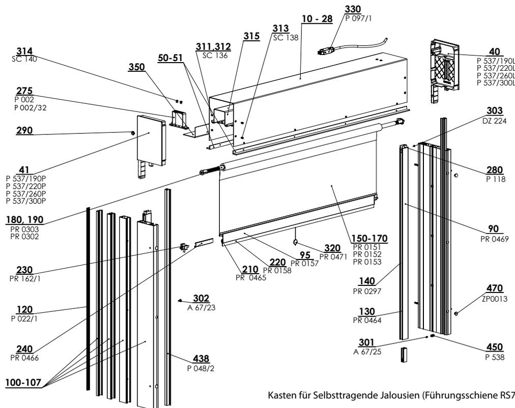
Kasten für Selbsttragende Jalousien (Führungsschiene RS75)
