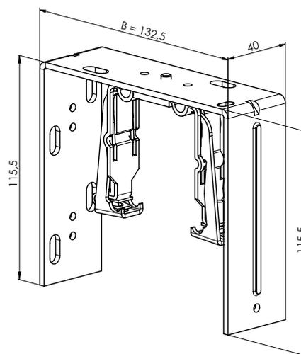
Doppelhalter mechanisch - verstellbar kurz 106-163 mm
