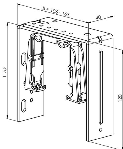
Doppelhalter mechanisch - verstellbar lang 165 - 223 mm
