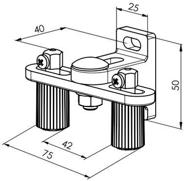
Spannwinkel doppelt, 48 - 75 mm P032/7 (2-01653)
