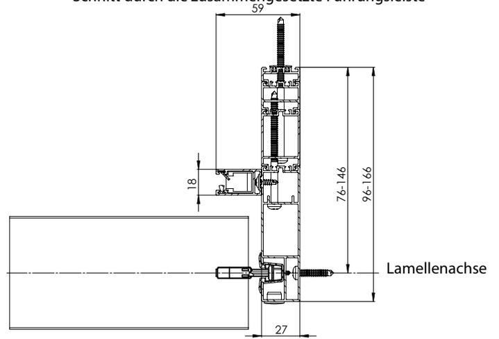
Schnitt Detail des Insektenschutzgitters
