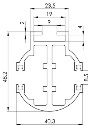
**Führungsleiste FIX (P018/2 FIX)**
