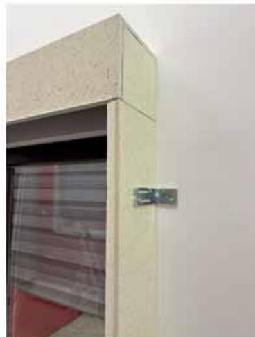
Optional bieten wir auch die SIO-Laibung an, welche nur aus Polystyrol mit einer Einlage für die Führungsleiste gefertigt ist. Die Montage erfolgt durch Aufkleben mittels Schaumkleber auf das vorbereitete Kontakt-Wärmedämmsystem.
