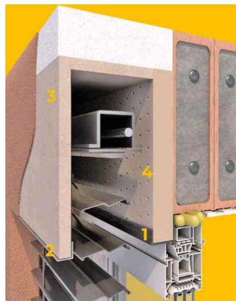
Das **Montage-U-Profil** ist nicht nur eines der Tragelemente des Kastens, sondern es bildet auch ein funktionsfähiges und ästhetisches Detail der Verbindung der Dämmung des Kastens an den Fensterrahmen.
